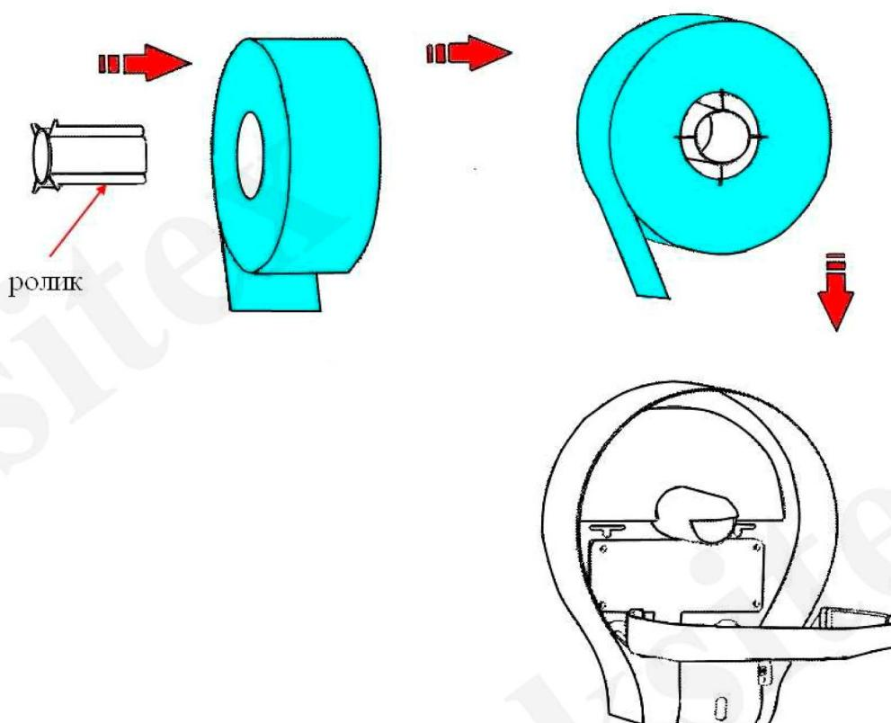
10 Вытяните бумагу к протяжному механизму и нажмите кнопку выдачи бумаги на лицевой стороне корпуса. Механизм протянет бумагу и выдаст ее из слота, а специальный нож ее отрежет.
